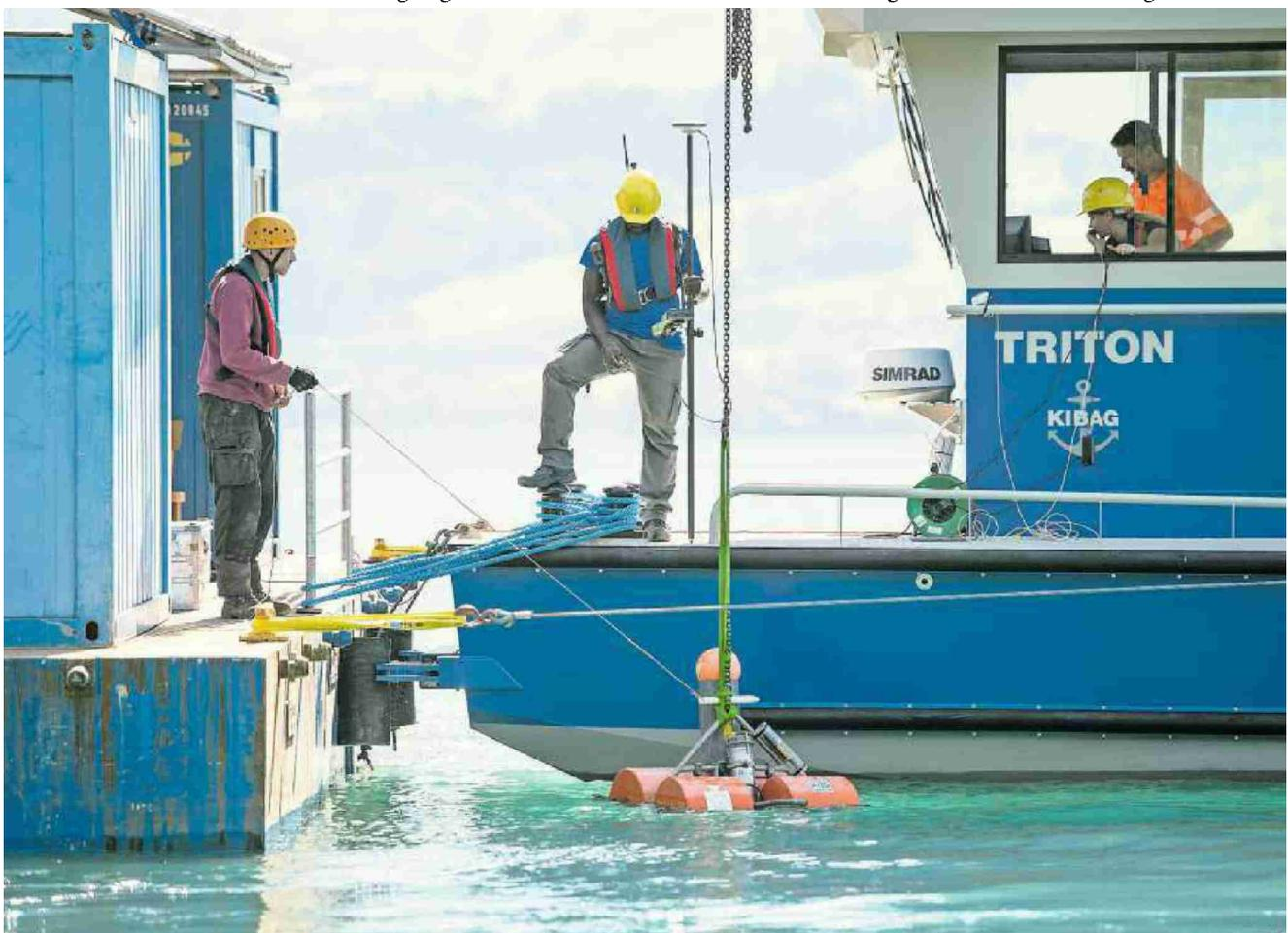
Von einer schwimmenden Plattform aus wird ein Seismometer im See versenkt.
